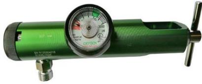
El regulador de oxígeno, fabricado de latón cromado (aleación de cobre y zinc) es el dispositivo que se ubica en la parte superior del cilindro de oxígeno. Su función es regular la salida de oxígeno que está almacenado en el cilindro. Cuenta con un manómetro para poder observar el nivel de carga de oxígeno y un sistema para regular el nivel de flujo de oxígeno. Su cuerpo más largo facilita la conexión de un vaso humidificador al darle un espacio más holgado con el cilindro.
