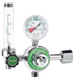
El regulador de oxígeno es el dispositivo que se ubica en la parte superior del cilindro de oxígeno. Su función es regular la salida de oxígeno que está almacenado en el cilindro. Cuenta con un manómetro para poder observar el nivel de carga de oxígeno y un sistema para programar el nivel de flujo de oxígeno.
